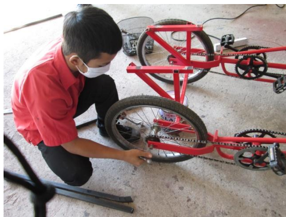
รูปภาพที่ 8 ถอดล้อเพื่อทำสีโครง
