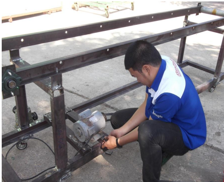
รูปที่ 17 ยึดมอเตอร์เข้ากับฐานที่เชื่อมไว้
