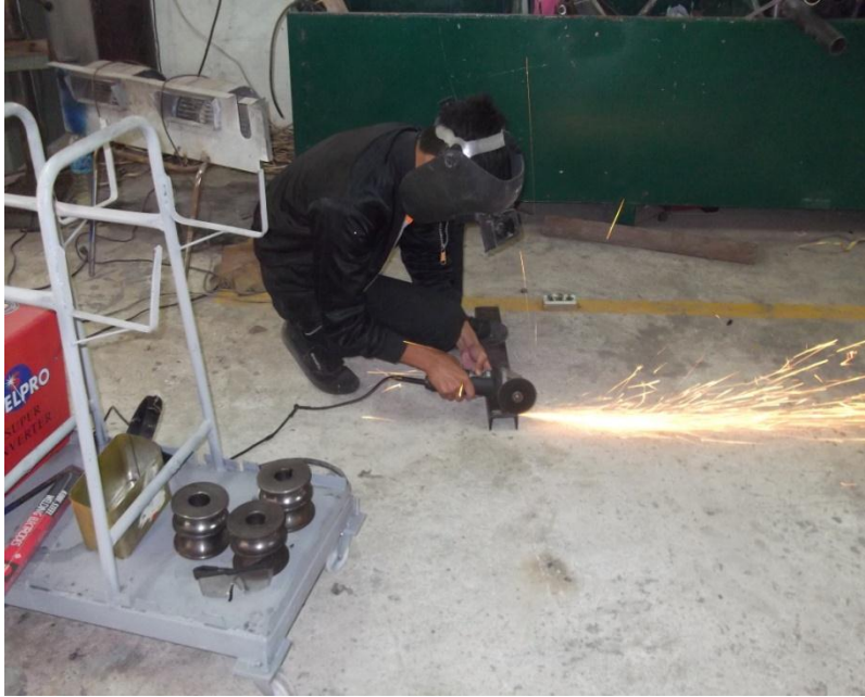
รูปที่ 12 ทำร่องเพื่อทำฐานมอเตอร์ และฐานเกียร์ทกรอบ
