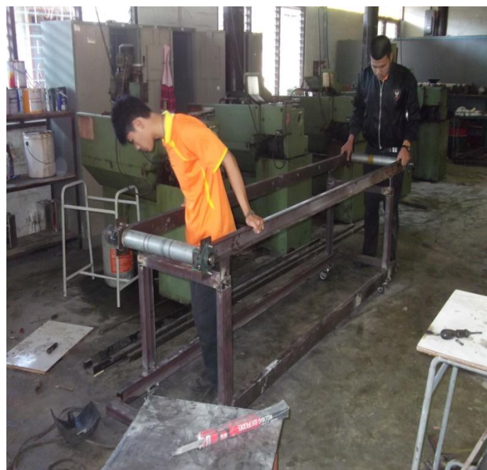
รูปที่ 15 ประกอบโครงสายพาน เข้ากับฐาน
