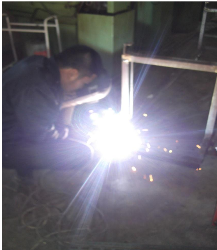
รูปที่ 13 เชื่อมโครงฐานของสายพานลำเลียง
