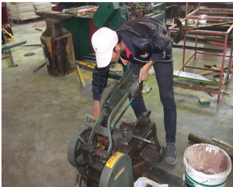
รูปที่ 10 ตัดเหล็ก ทำเพลลาของล้อกลิ้งของสายพาน
