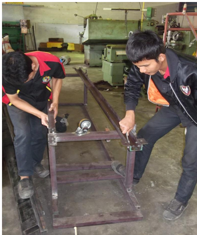
รูปที่ 14 ทำการประกอบล้อ เข้ากับโครงของสายพานลำเลียง
