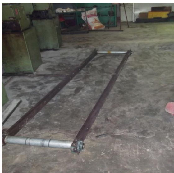
รูปที่ 11 ทำโครงของล้อกลิ้งสายพาน
