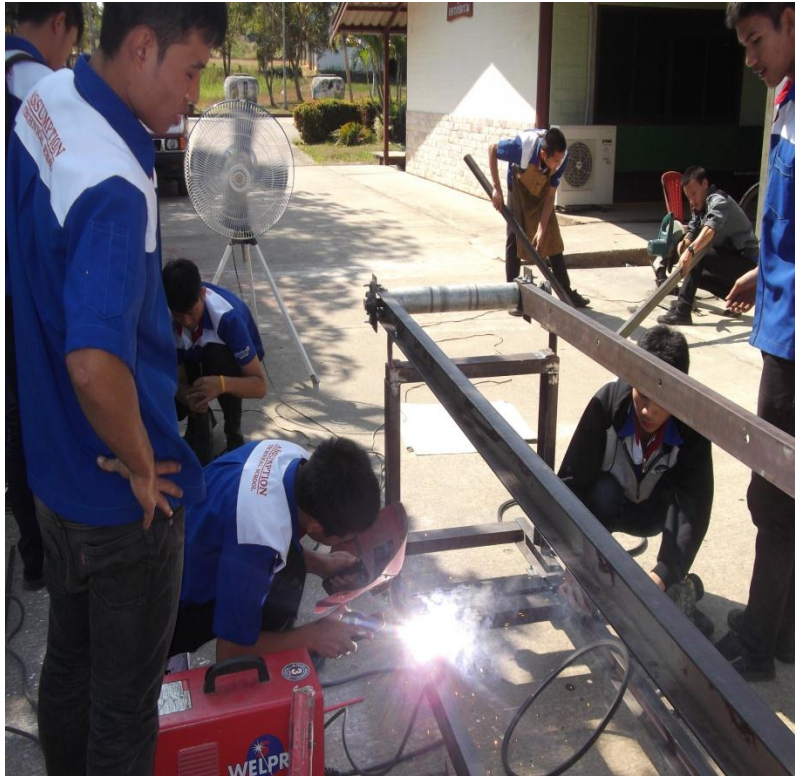
รูปที่ 16 เชื่อมฐานเพื่อตั้งมอเตอร์ และเกียร์ทครอบ
