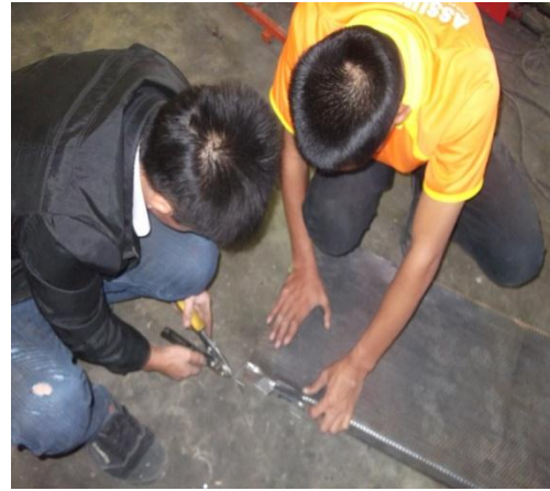
รูปที่ 3 ตัดเหล็กทำตะแกรงร้อนข้าว
