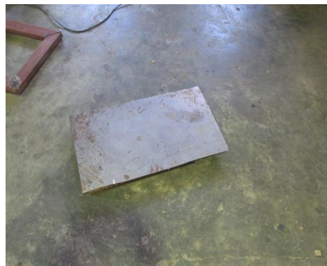
ภาพที่ 13 นำเหล็กแผ่นมาวางทาบและตัด
