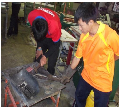
ภาพที่ 16 เชื่อมมิต HSS เข้ากับใบมีดเหล็ก
