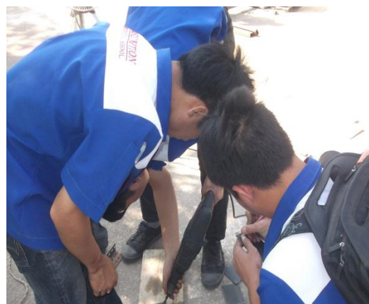
ภาพที่ 21 เจาะรูเหล็กแผ่นเพื่อที่จะใส่ล้อ
