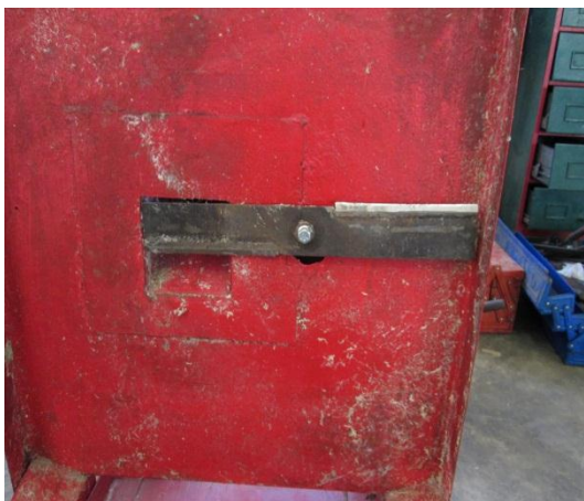
ภาพที่ 18 ภาพจากการประกอบใบมีด HSS
