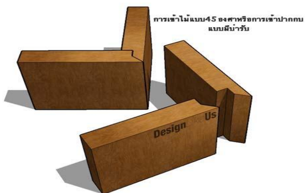
ภาพที่ 12 การเข้าไม้แบบนารับ
