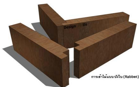
ภาพที่ 2 แสดงถึงการเข้าไม้แบบ บังใบ
