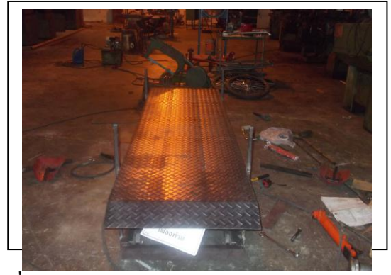
ภาพที่ 18 ประกอบเหล็กแผ่นลายใต้ฐานบน
