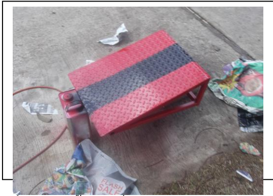
ภาพที่ 25 ทางขึ้นลิฟท์ที่มีพ่นสีเสร็จแล้ว
