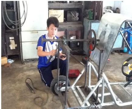
รูปที่ 12 การสร้างโครงเพื่อยึดแกนใบพัด
