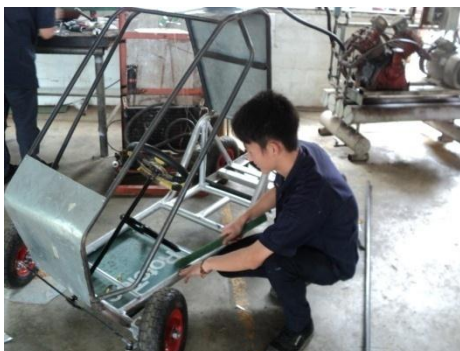
รูปที่ 8 ทำการเจาะรูเพื่อยึดหลังคา
