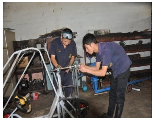
รูปที่26 ทำการติดตั้งแกนใบพัด
