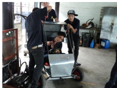
รูปที่ 9 ปรับแต่งฐานเพื่อยึดเครื่อง
