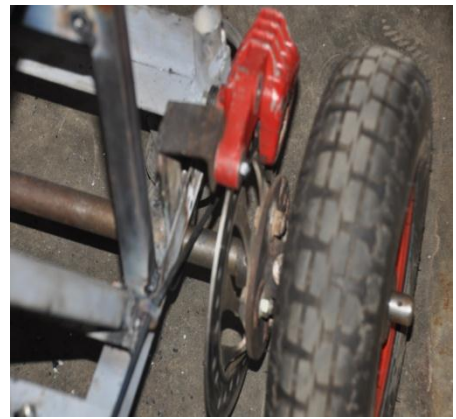
รูปที่ 18 ติดตั้งระบบเบรก
