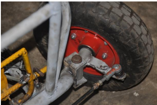
รูปที่ 17 ระบบเลี้ยว พวงมาลัย และคันเร่ง
