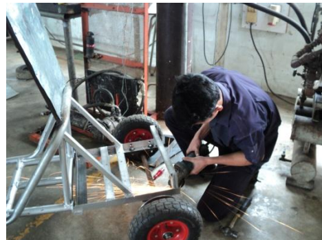
รูปที่ 9 ปรับแต่งฐานเพื่อยึดเครื่อง
