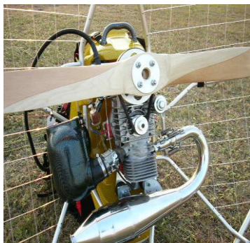
รูปที่1 ชุดเครื่องพารามอเตอร์
