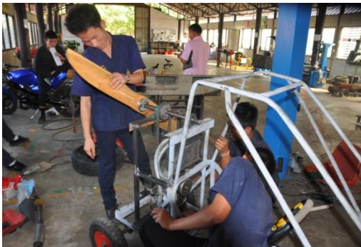
รูปที่23 การติดตั้งใบพัด
