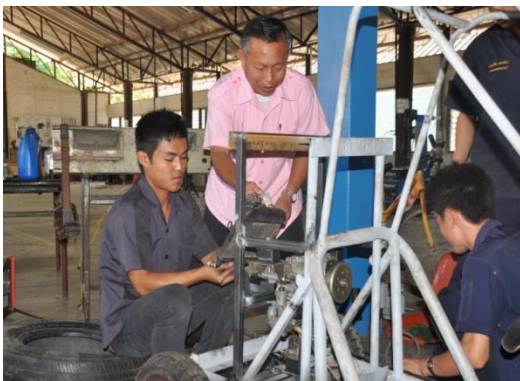
รูปที่25 กำลังติดตั้งหม้อน้ำ
