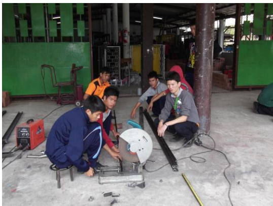
รูปที่ 10 การตัดเหล็กเพื่อที่จะนำไปประกอบ
