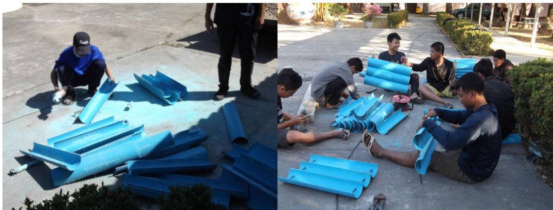
รูปที่ 20 การนำท่อpvcมาครึ่งทำเป็นไบพัต
