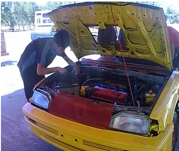
ภาพที่ 31 ขั้นตอนการปรับรอนเดินเบาของเครื่องยนต์ สมเกียรติ
