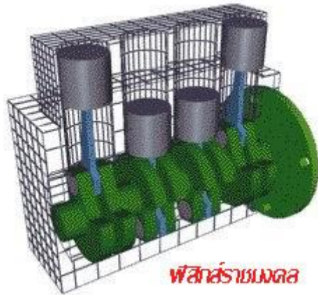
ภาพที่ 20 การเรียงของกระตุกสูบอยู่ในแนวเดียวกัน ในรูปเป็นเครื่องยนต์ขนาด 4 สูบ
