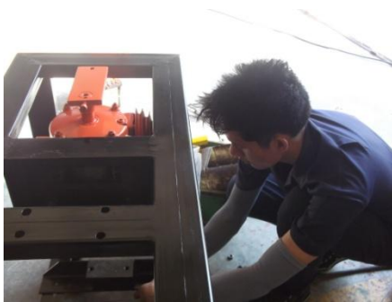
ภาพที่ 22 ทำการยึดมอเตอร์
