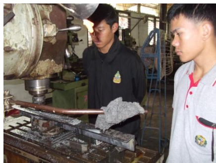
ภาพที่ 24-25 ทำการกัดเหล็กฉากเพื่อทำฐานมอเตอร์
