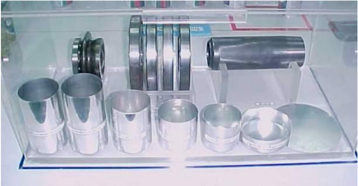
ภาพที่ 5 เครื่องอัดขึ้นรูปกระป๋องและส่วนประกอบของกระป๋อง
