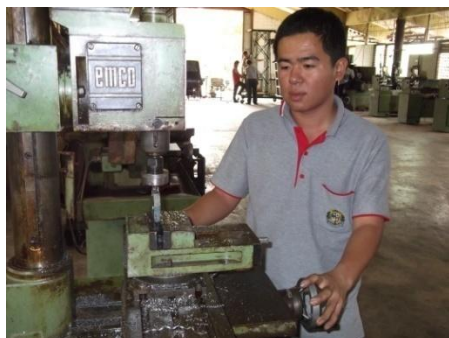
ภาพที่ 26 ทำการกัดก้านสูบ
