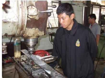
ภาพที่ 24-25 ทำการกัดเหล็กฉากเพื่อทำฐานมอเตอร์
