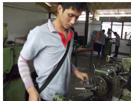
ภาพที่ 23 ทำการกลึงสลักลูกสูบ
