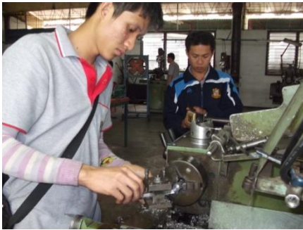
ภาพที่ 9-10 ทำการกลึง กัดงานตามแบบที่กำหนดไว้
