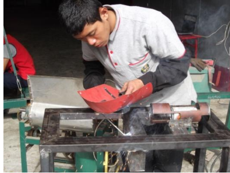
ภาพที่ 7-8 ทำฐานและ โครงสร้างของเครื่องอัดกระป๋อง
