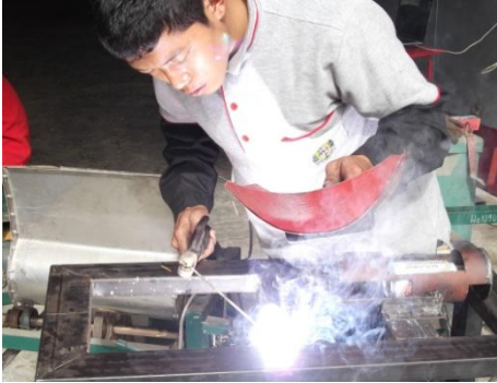
ภาพที่ 7-8 ทำฐานและ โครงสร้างของเครื่องอัดกระป๋อง
