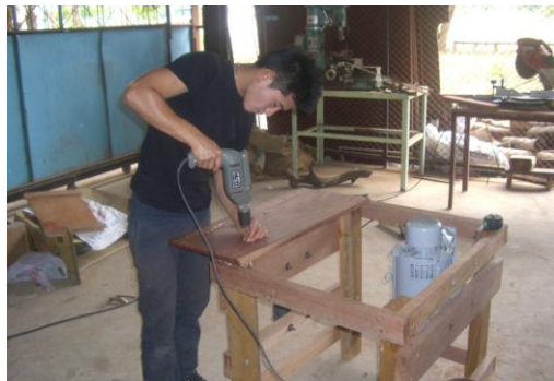
ภาพที่5.การติดตั้งหน้าโต๊ะ มอเตอร์
