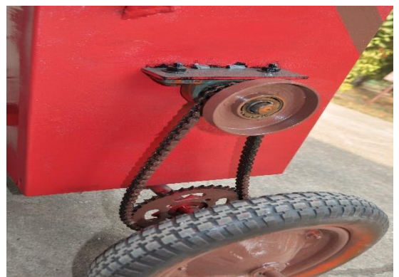
ภาพที่6 ภาพโซ่ขับเคลื่อนเพลาในรถ
