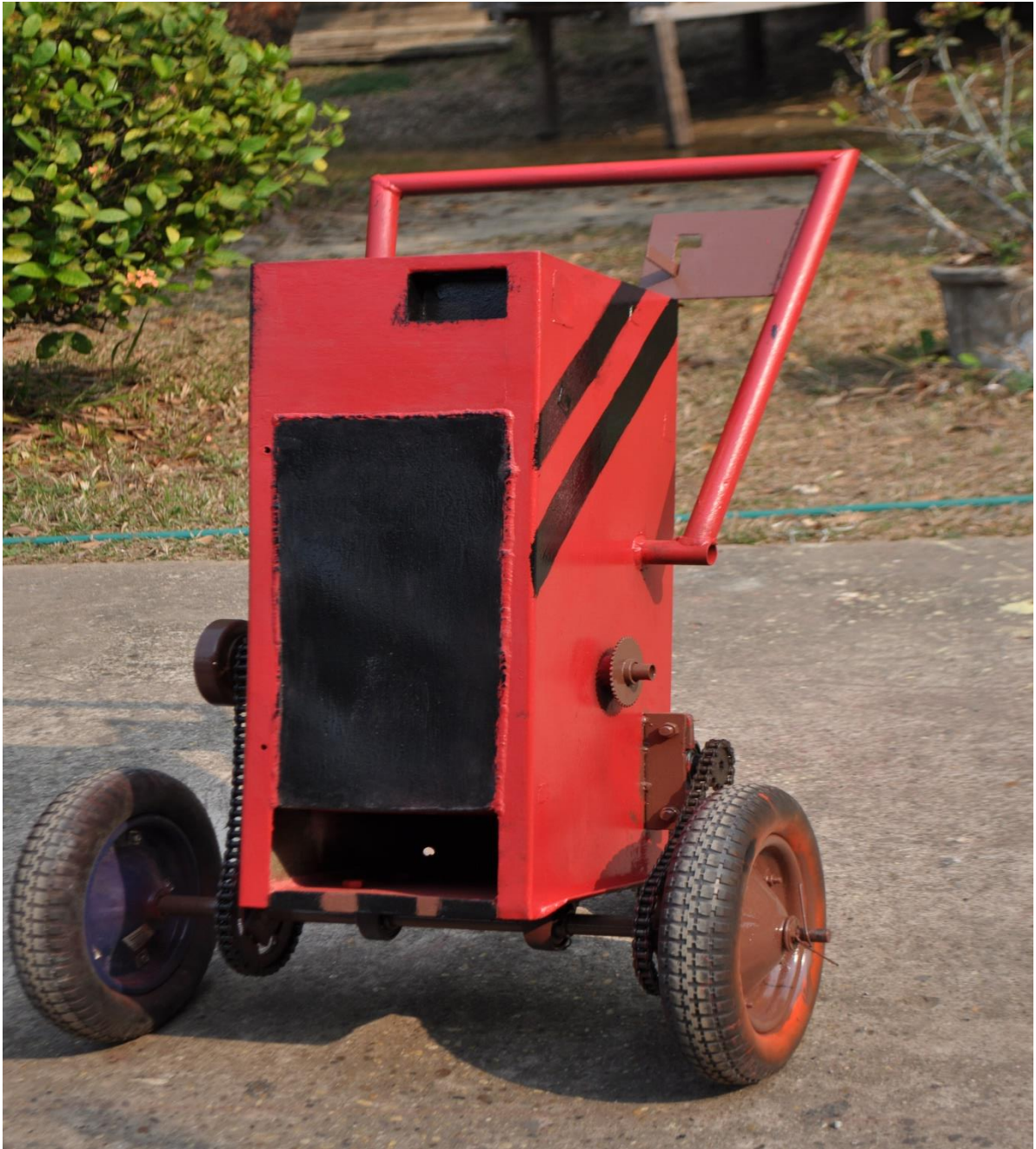
ภาพที่ 7 ภาพรถโรยปูนที่เสร็จแล้วพร้อมใช้งาน
