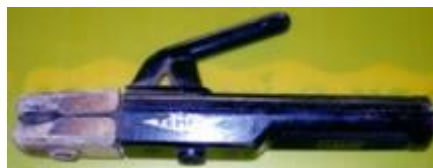
รูปภาพที่ 12 รูปแสดงหัวจับลวดเชื่อมไฟฟ้า
