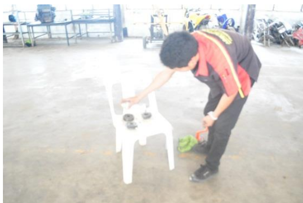
รูปภาพที่ 23 พ่นสีเสื่อเกียร์และเฟืองเกียร์และปล่อยให้สีแห้ง
