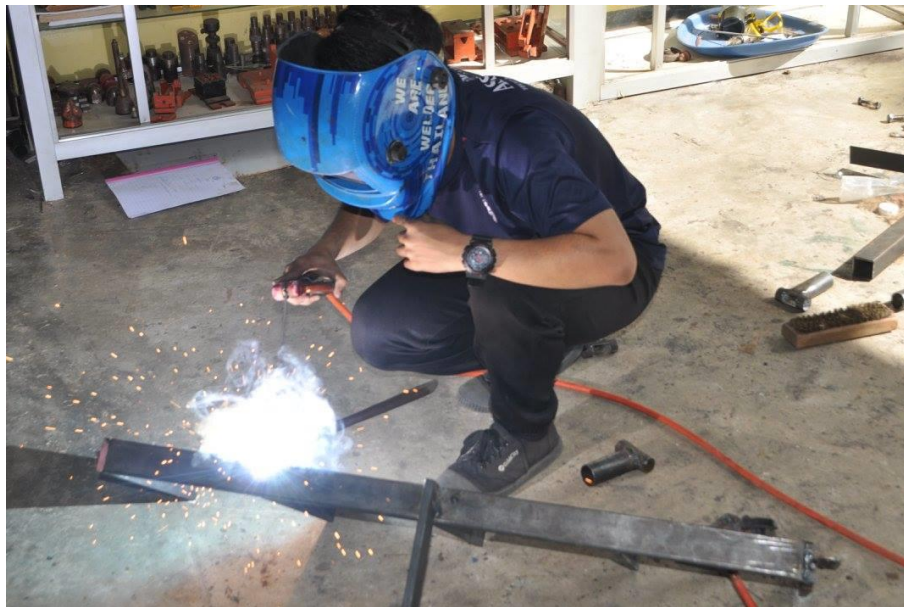
รูปภาพที่ 12 เชื่อมขึ้นรูปโครงสร้าง
