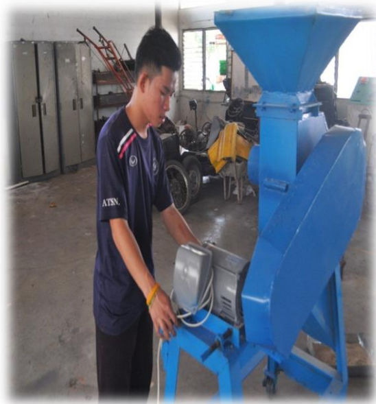
ภาพที่ 26 การต่อไฟฟ้าเข้าสู่มอเตอร์
