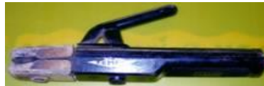
รูปที่ 11 แสดงหัวจับลวดเชื่อมไฟฟ้า (อารมณ. ภาพถ่ายดิจิทัล, 2550)
