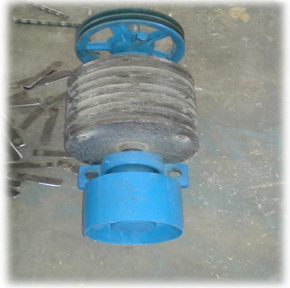
ภาพที่ 30 การถอดใบมีดออกมาล้าง
