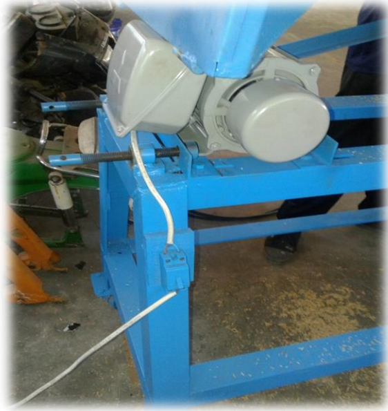
ภาพที่ 25 การติดตั้งมอเตอร์
