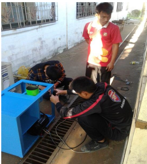
ภาพที่ 15 ติดตั้งมอเตอร์และตรวจสอบความเรียบร้อย
