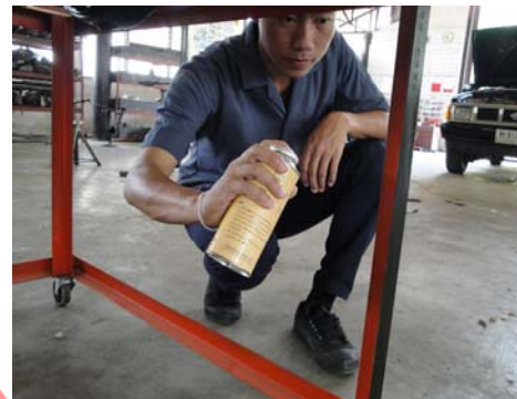
ภาพที่ 9 การพ่นสีโครงสร้าง
