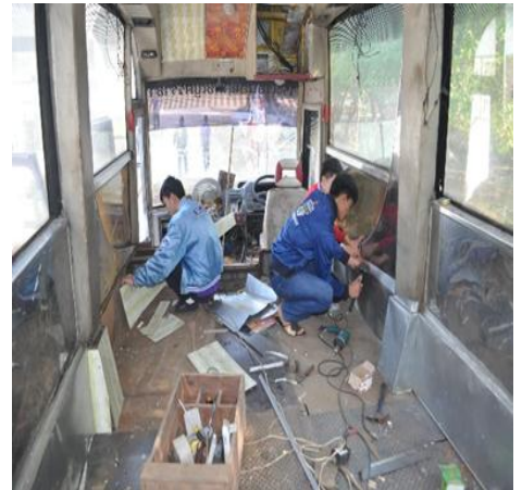
รูปภาพที่ 15 การติดตั้งแผ่นสังกะสีข้างตัวรถ
