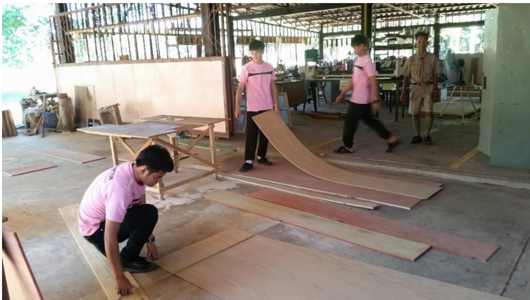
รูปภาพที่ 13 วัด และประกอบไม้อัด เป็น โครงโซฟา
