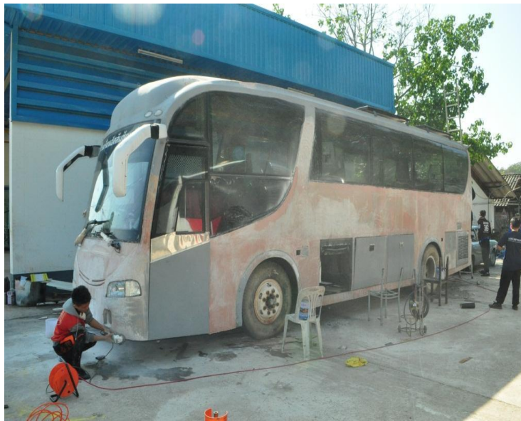
ภาพที่ 5 ชัดสีโป้วให้เนียน และเก็บรายละเอียด
