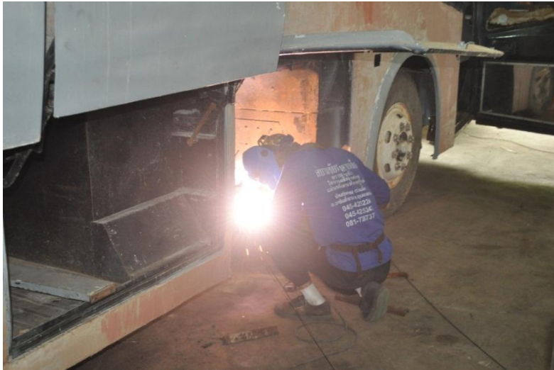
ภาพที่ 6 เชื่อมส่วนที่เป็นฐานวางแบตเตอรี่ และเครื่องแอร์รถ
