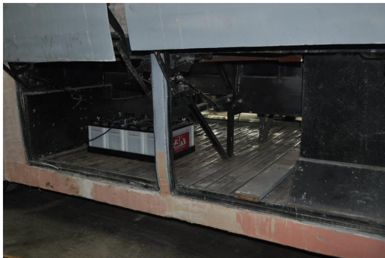
ภาพที่ 7 ฐานวางแบตเตอรี่ที่ทำขึ้นมาใหม่
