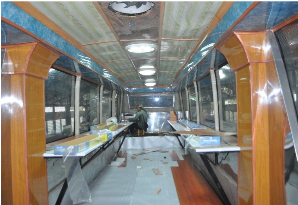
รูปภาพที่ 41 การปูแผ่นลามิเนตและเก็บรายละเอียด
