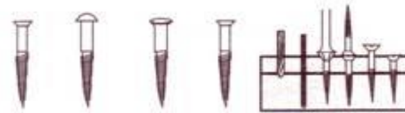
รูปภาพที่ 28 แสดงการยึดตรึงไม้ด้วยตะปูเกลียว
