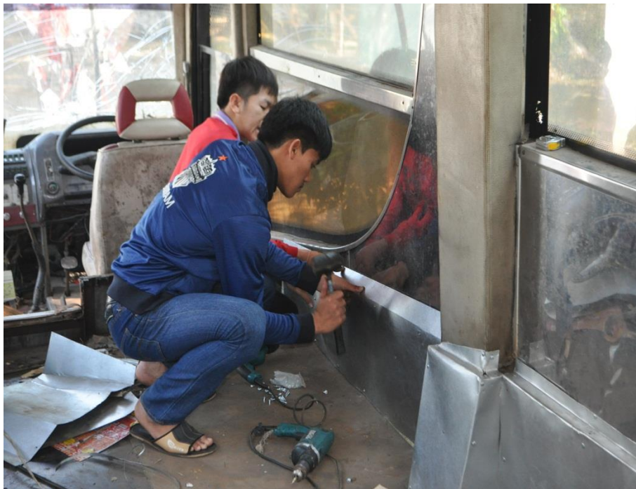
รูปภาพที่ 39 ติดแผ่นสแตนเลสเพื่อเก็บปิดรอยเก่า
