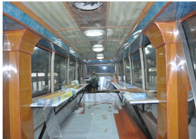
รูปภาพที่ 35 ปูโฟมเพื่อรองรับแผ่นลามิเนต
