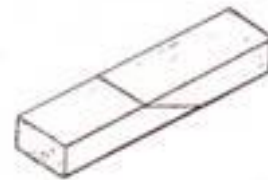
รูปภาพที่ 16 แสดงการต่อชนแบบชนเฉียง
