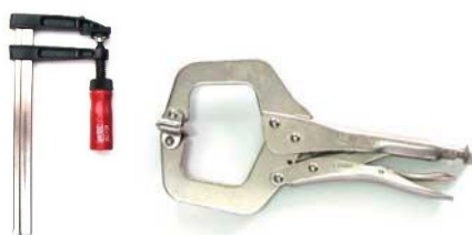
รูปภาพที่ 11 C แคลมป์ใช้บีบอัดกรณีที่ต้องการความแน่นมาก
