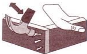
รูปภาพที่ 24 แสดงการเข้าไม้แบบชนฉากธรรมดา
