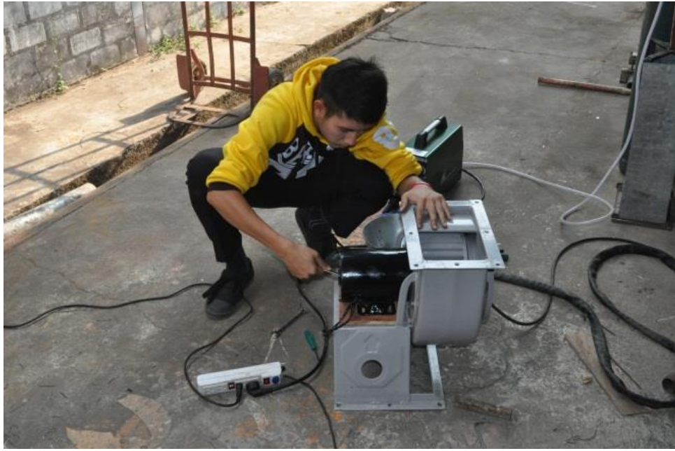
รูปภาพที่ 17 ประกอบมอเตอร์กับพัดลมหอยโข่ง
