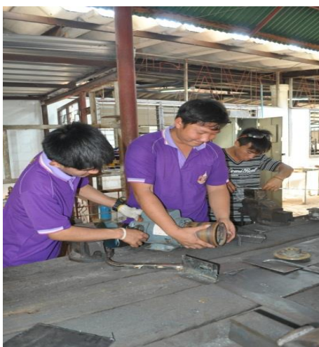
ภาพที่ 18 นำมู่เลย์มาประกอบเข้ากับมอเตอร์
