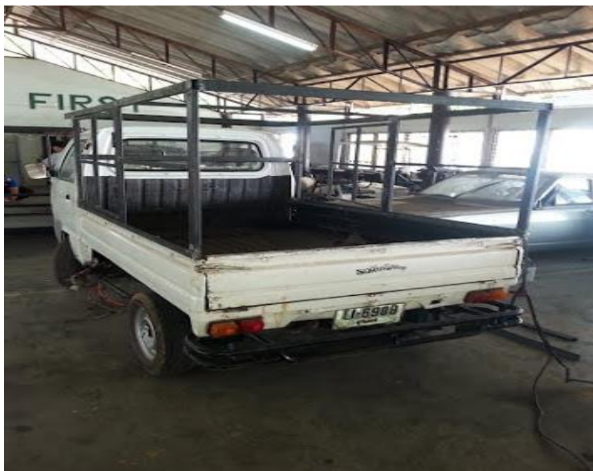
รูปภาพที่ 6 โครงหลังคารถ
