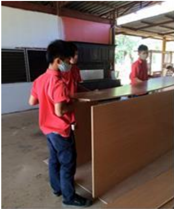
ภาพที่ 33 กำลังประกอบ โครงตู้
