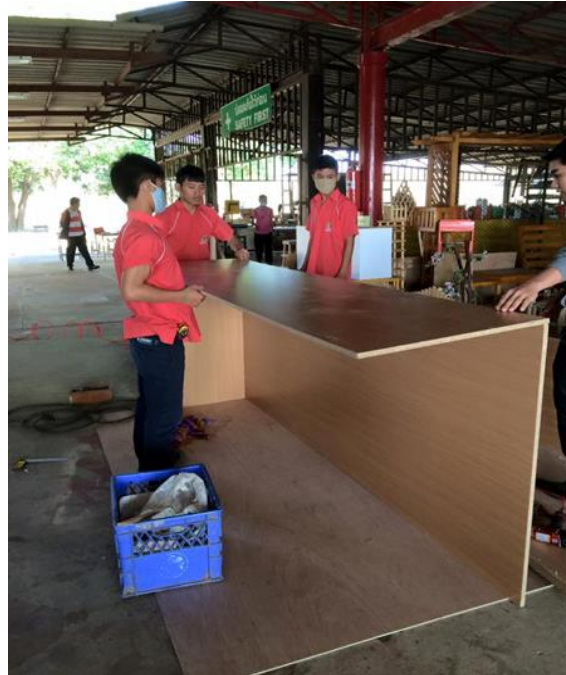
ภาพที่ 34 กำลังประกอบ โครงตู้
