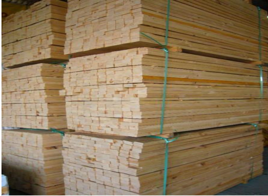
ภาพที่ 8 ไม้สนอบแห้งเกรดสำหรับทำลังไม้ หรือ พาเลท
