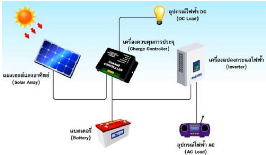
ภาพที่ 3 อุปกรณ์ระบบการผลิตกระแสไฟฟ้าจากเซลล์แสงอาทิตย์
