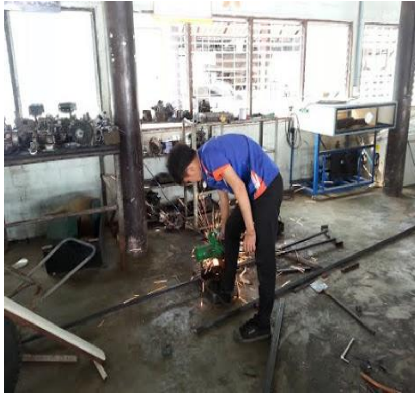
ภาพที่22 การตัดเหล็ก
