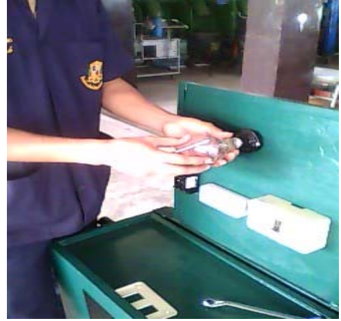
ภาพที่ 21 ต่อหลอดไฟเข้าแผงวงจร
