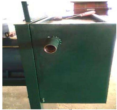
ภาพที่ 23 ท่อทางน้ำเข้าหัวฉีด
