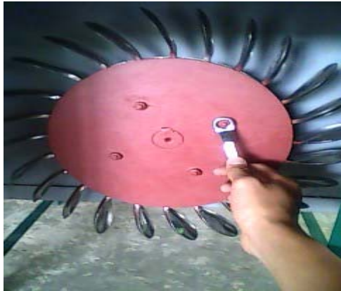
ภาพที่ 14 การติดตั้งใบพัด
