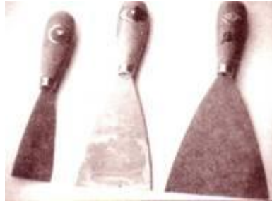
รูปภาพที่ 5 เกรียงขูด-โป้วตี (ณรงค์ และบุญชู.งานช่างพื้นฐาน, 2542:189 )
