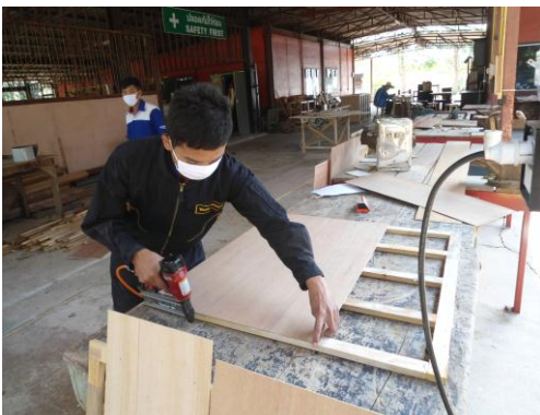
ภาพที่ 25 กำลังยิงไม้อัดใส่แผง
