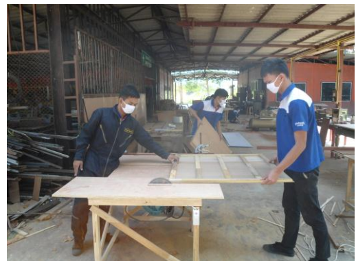
ภาพที่ 26 กำลังชวยแผงให้ได้นขนาด
