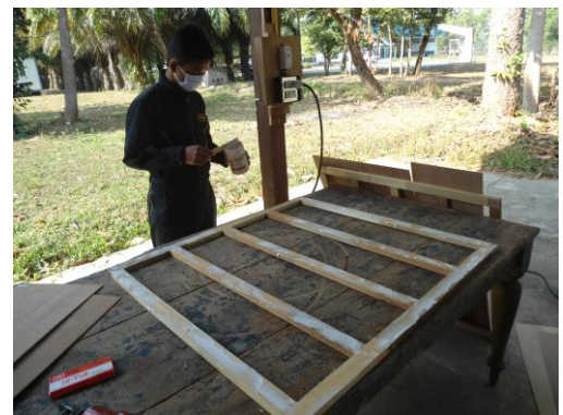
ภาพที่ 24 กำลังทากาวแผงที่ยิงไว้แผง
