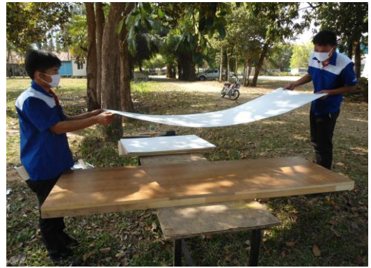
ภาพที่ 28 กำลังติดโฟมก้ำใส่แผงที่ทากาวยางไว้
