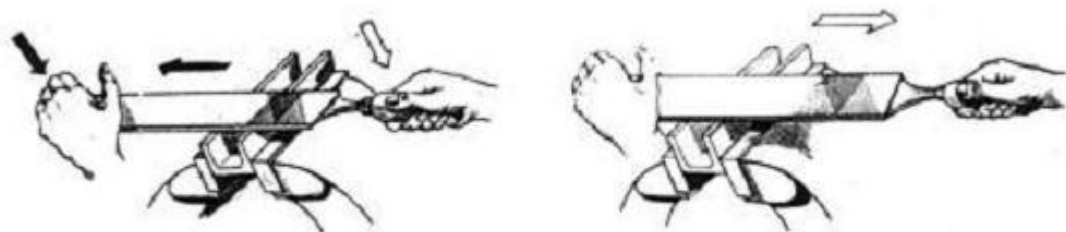
ภาพที่ 5 แสดงวิธีการตะไบ
