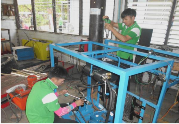
ภาพที่ 8 เจาะรูยึดแผ่นอะคริลิกด้านข้าง
