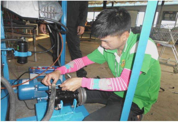
ภาพที่ 16 พันท์เปพันสายตรงเกลียวคอนเดนเซอร์
