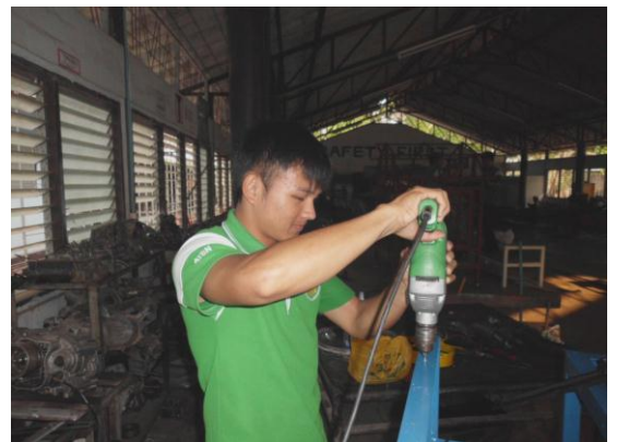
ภาพที่ 7 เจาะรูยึดแผ่นอะคริลิคด้านบน
