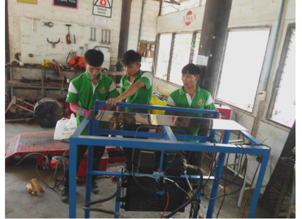
ภาพที่ 15 การยิงลูกริเวทเพื่อยึดแผ่นอะคริลิคด้านบน
