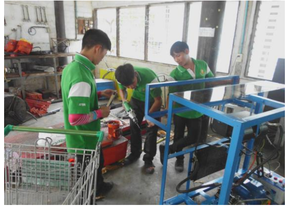
ภาพที่ 9 เจาะรูยึดแผ่นอะคริลิกด้านหน้า
