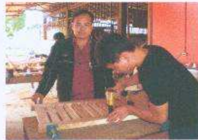
ใช้เครื่องบึงตะปูยึดตรึงให้แน่น
